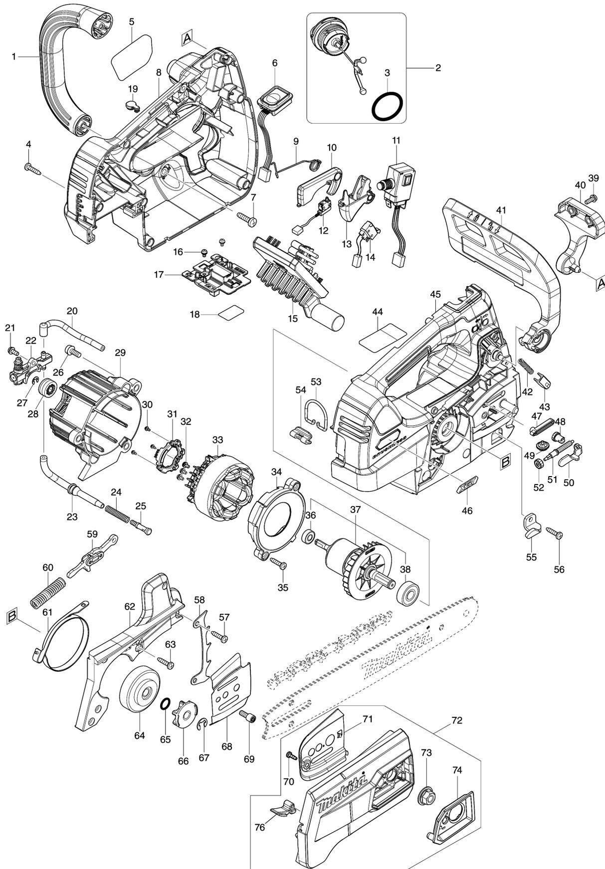
Model No.UC003G 300MM CORDLESS CHAIN SAW
