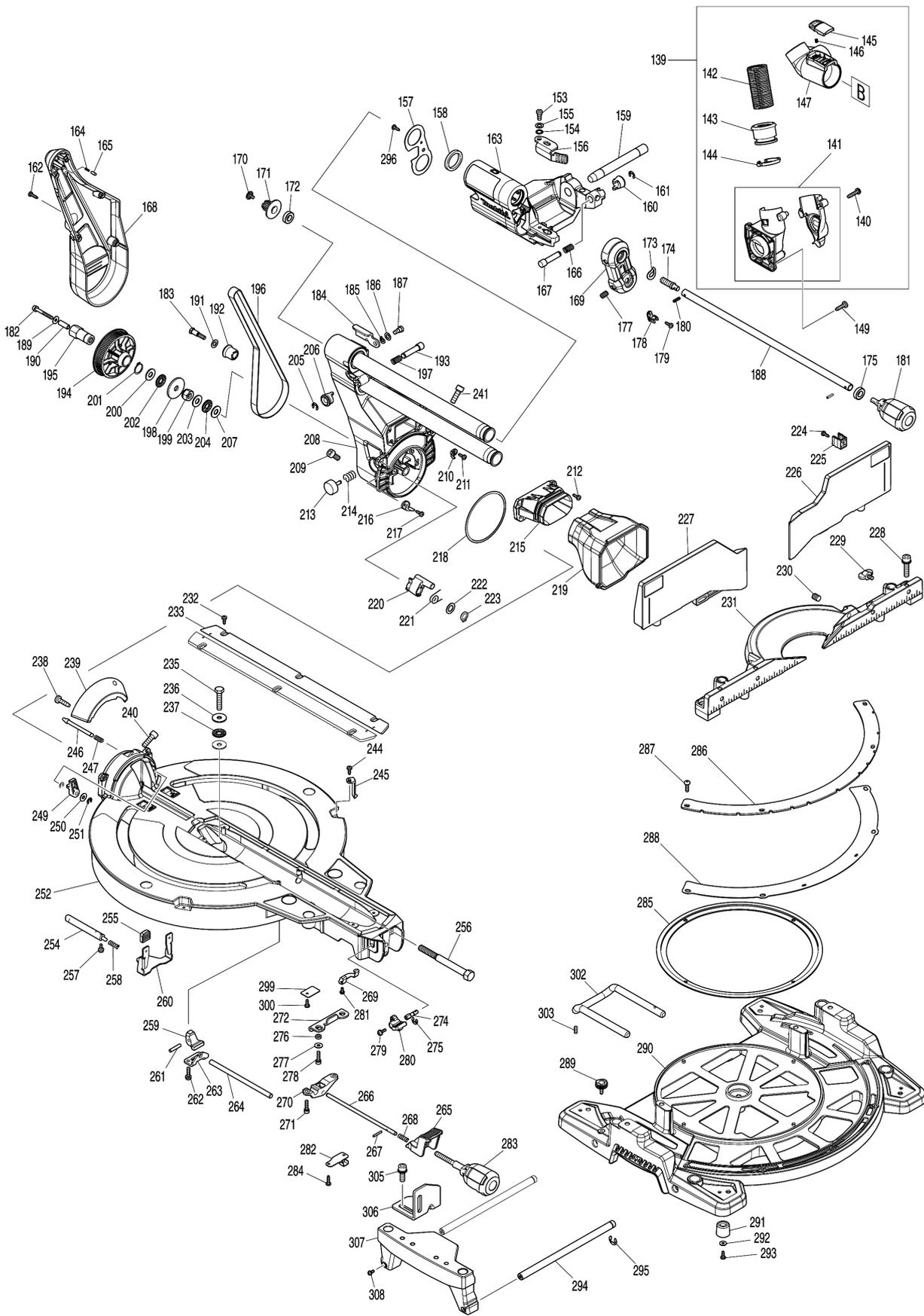
Model No.LS003G 305MM DC SLIDE CPD. MITER SAW
